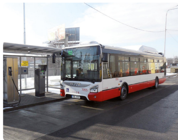
Čerpací stanice CNG.
