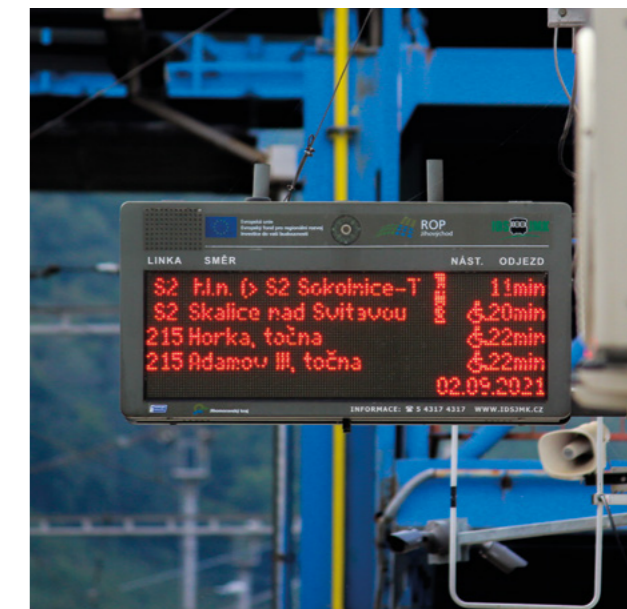
Elektronické informační panely (ELPy) jsou v Brně i zbytku kraje instalovány již delší dobu. Cestující oceňují, že nemusí hledat informace o odjezdech v jízdních řádech. Dozvědí se, za jak dlouho přijede jejich spoj v reálném čase.
