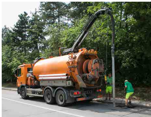
Mercedes-Benz s nástavbou pro čištění uličních vpustí.
