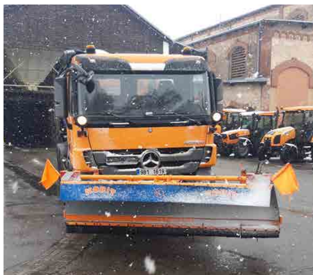
Posypový vůz MB s čelním pluhem Kubit.
