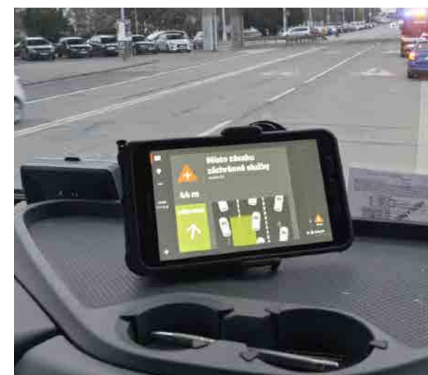
Testování funkčnosti systému C-ITS v Brně, na snímku C-ITS jednotka OBU (on-board unit).
