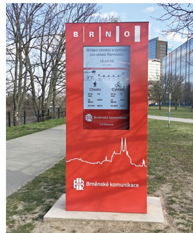
Totem zobrazující data sčítání chodců a cyklistů na Renneské třídě, který je součástí instalace měřicích bodů na cyklostezkách v rámci projektu Řízení dopravy a sběr dopravních dat ve městě Brně, 2. etapa.
