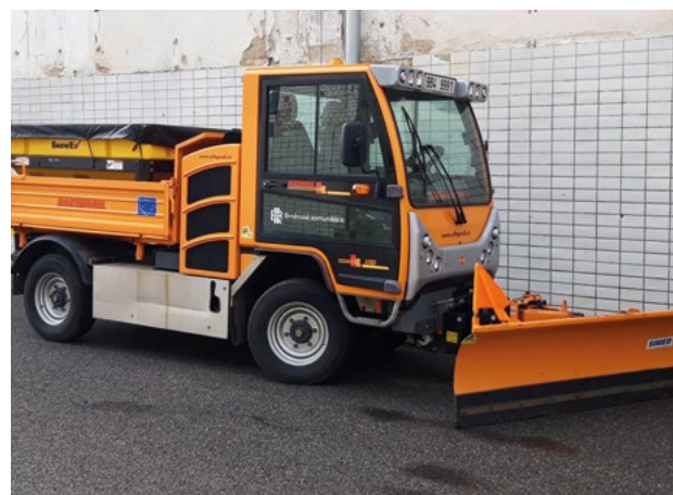
Víceúčelové vozidlo Bokimobil v zimní úpravě.
