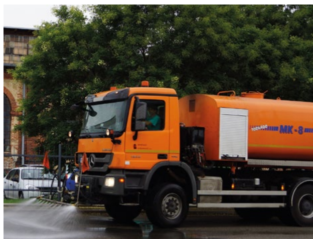
Splachování komunikací vozidlem s mycí nástavbou.
