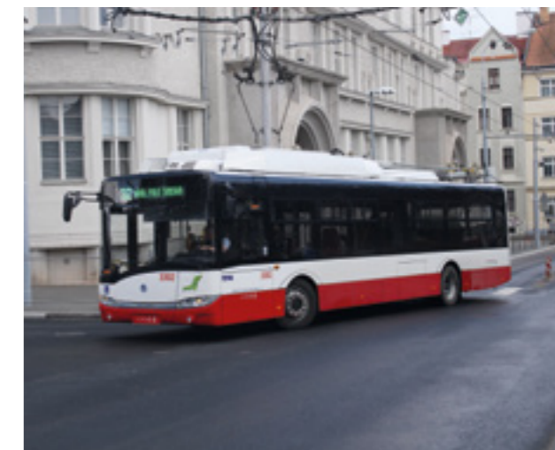
Trolejbus ŠKODA 26Tr (parciální) v úseku bez trolejového vedení.
