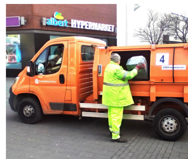
Vozidlo Citroën s lineární lisovací nástavbou.
