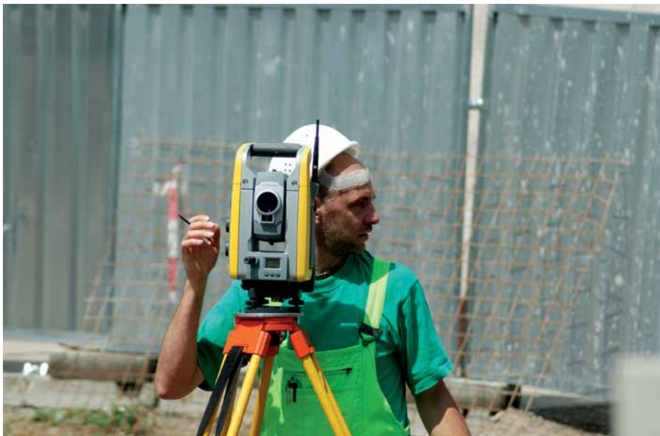
Obr. 9 – měření s Trimble S-6
