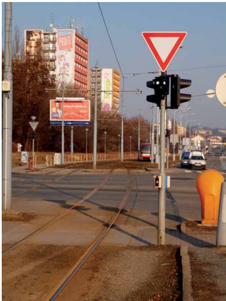
Tramvajové návěstidlo s technologií LED je pro řidiče tramvaje lépe pozorovatelné než tramvajové návěstidlo užívané klasických žárovek 25 W/230 V E27
