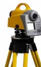
Obr. 5 elektronická měřící nivelační stanice Trimble DiNi 03
